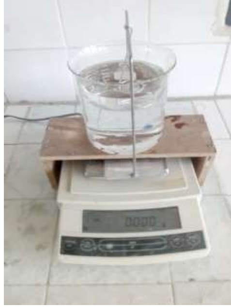
Şekil 4.33 Archimed deney düzeneği
