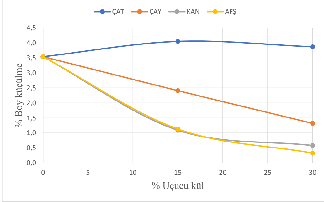
Şekil 5.13 1050 °C de pişirilen karo numunelerinin uçucu kül- boyca küçülme grafiği
