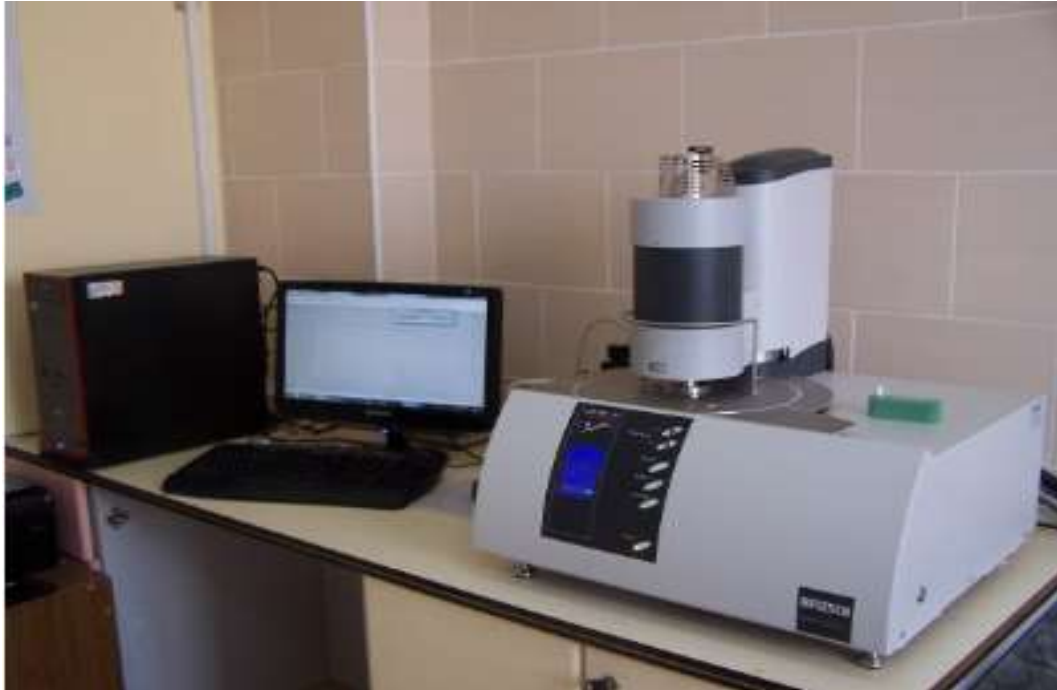
Şekil 4.36 Diferansiyel taramalı kalorimetri cihazı (NETZSCH).
