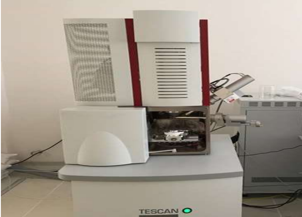
Şekil 4.40 Taramalı elektron mikroskobu cihazı (Mira3XMU FE-SEM (Tescan®, Çek Cumhuriyeti))
