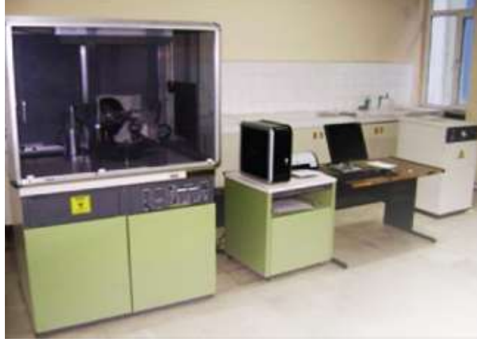
Şekil 4.38 Rigaku D-max XRD cihazı
