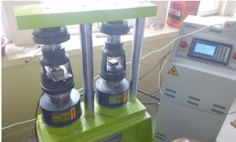
Şekil 4.35 Üç nokta eğme test cihazı
