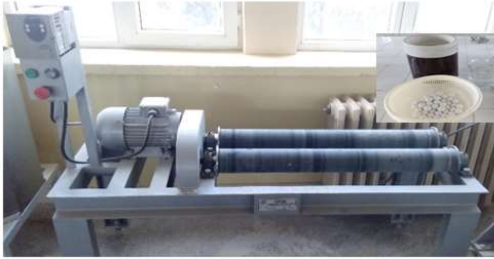
Şekil 4.28 Deneysel çalışmalarda kullanılan bilyalı değirmen
